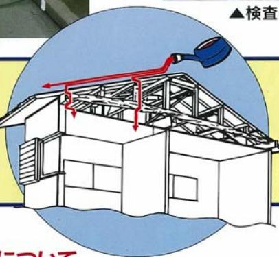
2. 屋根裏側から紫外線放射装置で照らすことにより、検査液を青白く発光させ、浸入の経路や雨もりの箇所を見つけだす。
